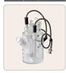
При заказе данной ячейки, титратор КF-31 может использоваться в режиме кулонометра.
