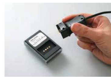
Перед выполнением измерений необходимо проверить зонды
